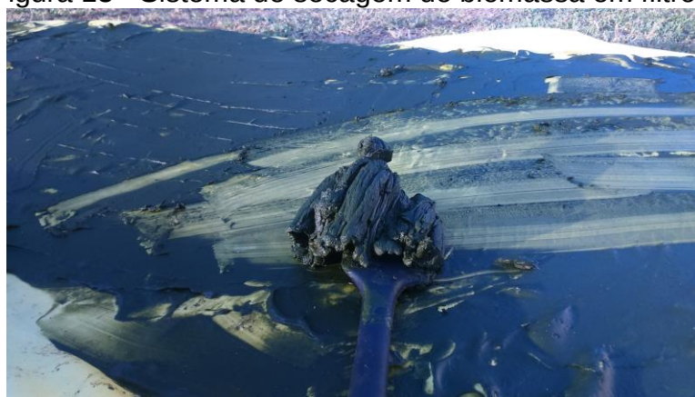
Figura 13 - Sistema de secagem de biomassa em filtros.
