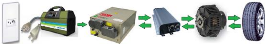
Figura 5 - Configuração de um veículo elétrico puro
