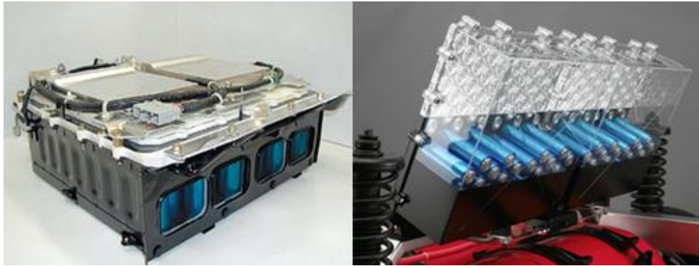
Figura 31 - Ultracapacitores, módulo de sistema Honda Fonte: Honda Worldwide, 2013
