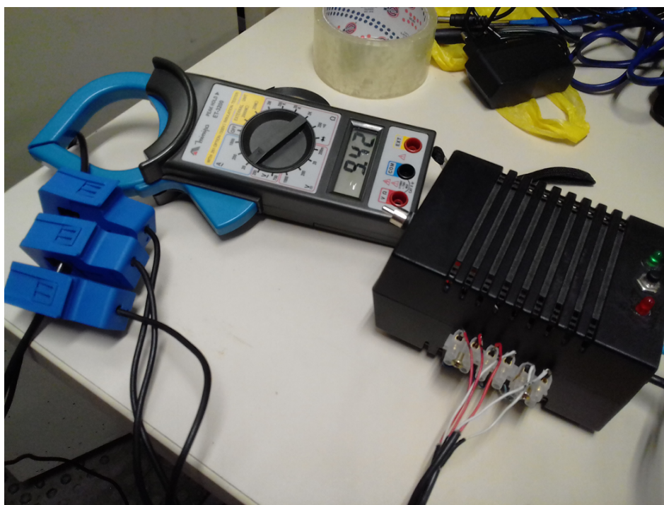
Figura 28 – Testes de medição com os sensores de correntes SCT013-100A
