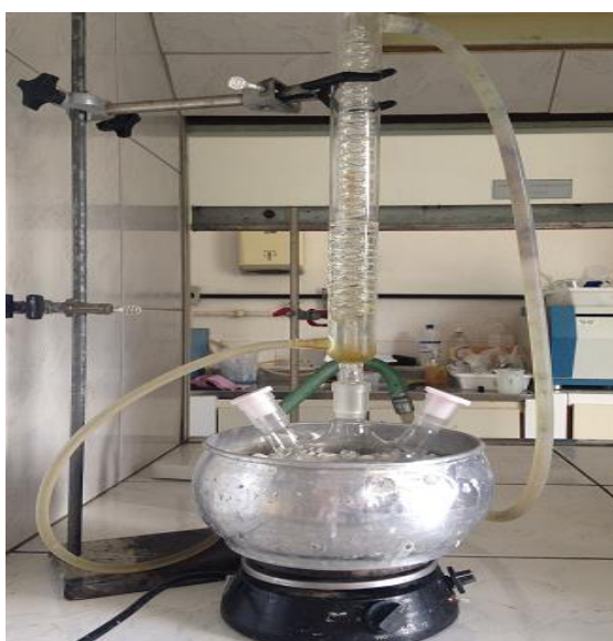
Figura 6 – Montagem do aparato experimental para a reação de produção de acetinas
