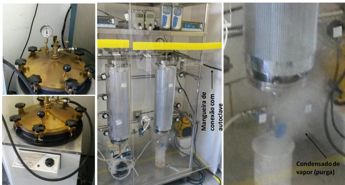
Figura 16: Desenho esquemático da esterilização do biorreator com vapor. Utilizado uma unidade de autoclave com potência elétrica de 3 kW para gerar vapor, e abastecer o biorreator através da conexão com uma mangueira de alta resistência capaz de suportar até 5 kgf/cm<sup>2</sup> de pressão e temperatura de até 300 °C.
