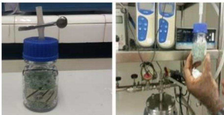
Figura 18: Dispositivo tipo *shot* para abrigar o indicador biológico
