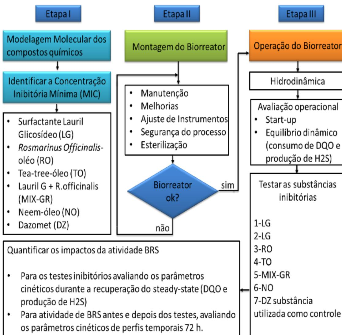
Figura 3: Diagrama mostrando as fases dos experimentos no biorreator: (Fase 1) Modelagem molecular e Determinação da (MIC) dos compostos químicos; (Fase 2) Montagem e manutenção do biorreator; (Fase 3) Operação do biorreator e Hidrodinâmica.
