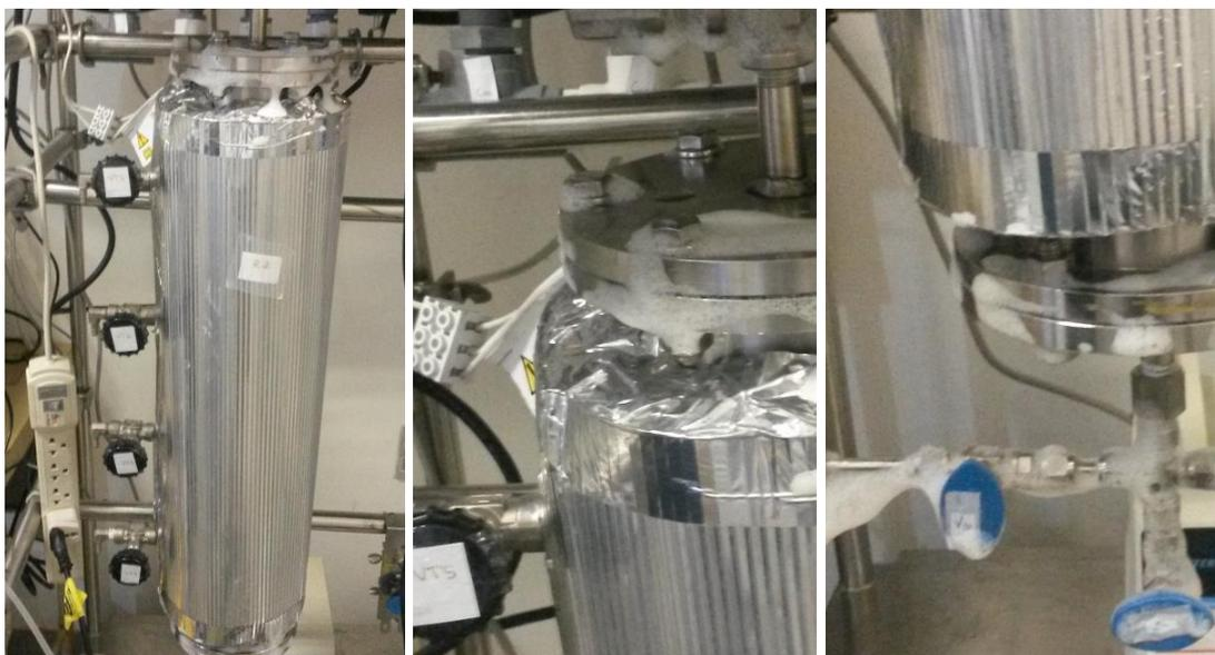
Figura 13: Teste com injeção de ar comprimido em todas as conexões e pontos de acesso ao biorreator, e uso de espumas de sabão para identificar possíveis vazamentos.
