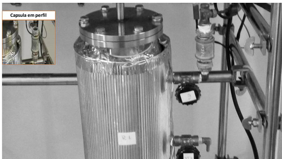
Figura 19: Suporte tipo cápsula para abrigar o indicador biológico. O suporte foi instalado no ponto de amostragem com maior resistência ao deslocamento de fluido (P1).
