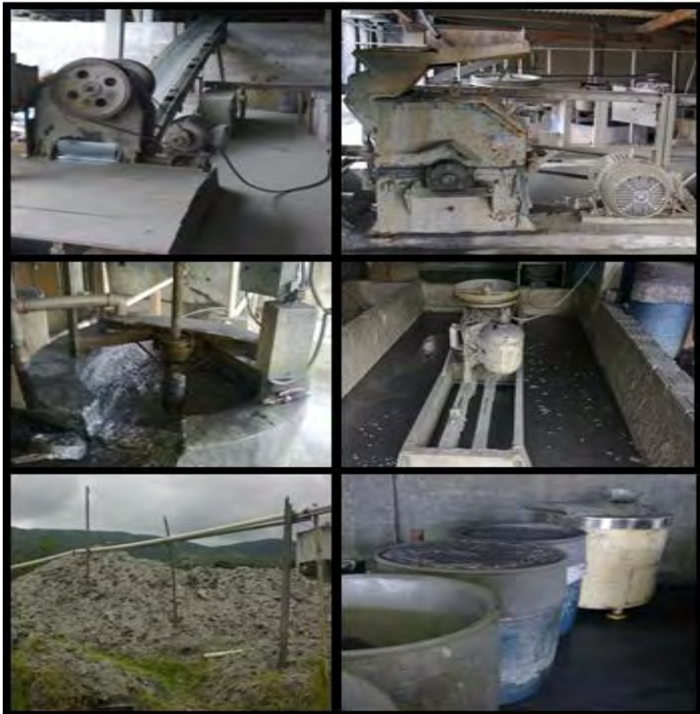
Figura 1.4 - Produção artesanal do concentrado de molibdenita no garimpo de Carnaíba - BA.
