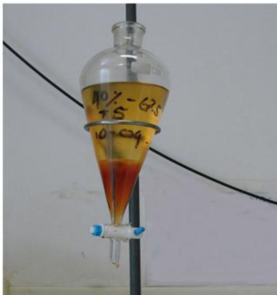
Figura 17 - Mistura biodiesel/glicerina em repouso, visando à separação de fases. Fase clara: biodiesel; fase escura glicerina bruta.
