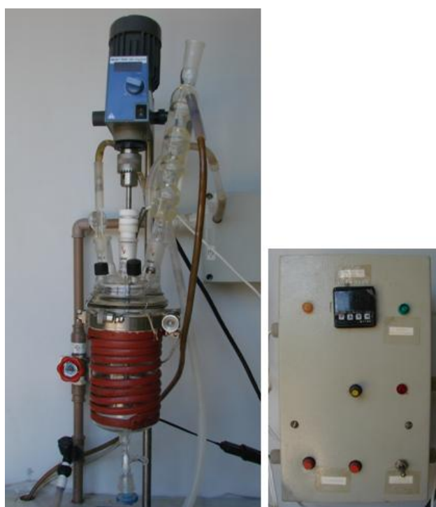
Figura 16 - Reator de vidro e controlador de temperatura PID marca Novus modelo 1100
