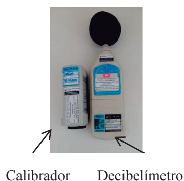
Figura 11b- Fundo dos equipamentos com o certificado de calibração
